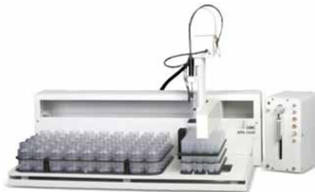
图3 配合Optima 8300 ICP-OES使用的CETAC® APS-1650自动制备站
