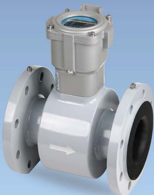
KEFS二供专用型智能电磁流量计是上海肯特专门针对高层建筑的二次供水设备的应用特点而特别设计的,可以通过计量二供的累计水量和用电量计算出二供设备的实际能耗,通过更换合理水泵或改变控制策略等措施达到节能的效果,还可以通过流量突变测量夜间量小流量,核算总分差异技术,及时发现爆管,泄露和偷盗水。
